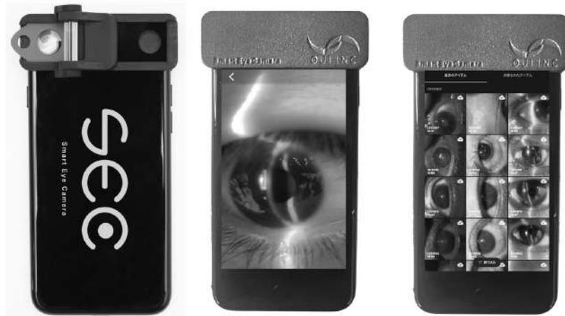
図1 ファイリングシステム付きの手持ち細隙灯顕微鏡：Smart Eye Camera
