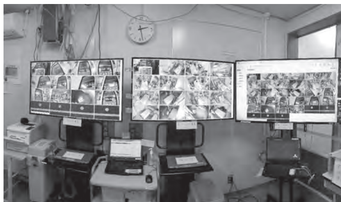
図5 COVID-19病棟の遠隔モニタリングシステム(全ての患者の画像モニターと人工呼吸器画面)
